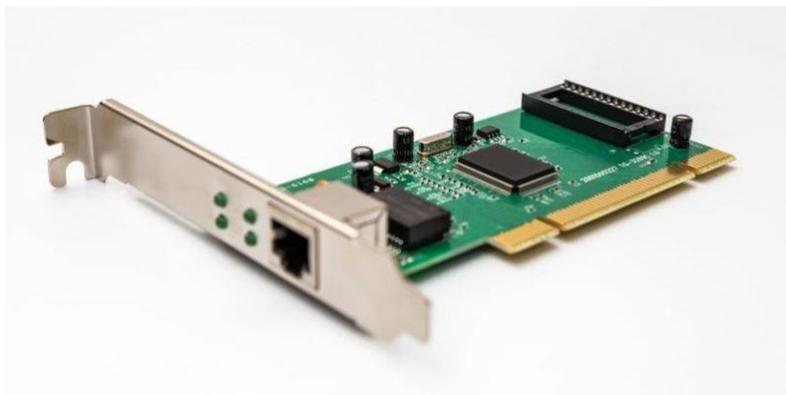
Ilustración 7. Imagen de una tarjeta de red
