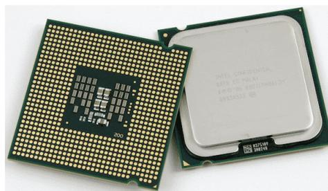
*Ilustración 2. Imagen de un procesador vista superior e inferior*
