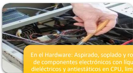
En el Hardware: Aspirado, soplado y rociado de componentes electrónicos con líquidos dieléctricos y antiestáticos en CPU, limpieza de mouse y teclado, limpieza de cabezas de unidades de diskette, lubricación de partes y limpieza de superficies. En Impresoras: Aspirado y soplado, lubricación, ajuste de partes y limpieza de superficies.
