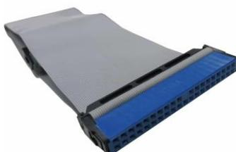
Es un conjunto de conexiones físicas que trasfieren información de un sitio a otro. A través de ellos se transmite todo tipo de información y de datos que se enlazan entre sí, con las partes internas de la computadora.
