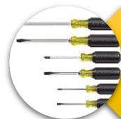
Un juego de desarmadores (estrella, hexagonal y paleta). Esenciales para el desarmado y armado de cada una de las partes.
