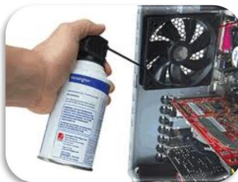
Fig. 1.6 Mantenimiento, materiales para limpieza interna y externa de pc.
